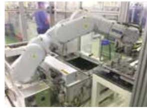
ロボット半田ライン(深圳工場)
